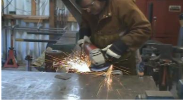
Fotoğraf 1.2: Seyyar zımpara ile kaynak ağızı açma
